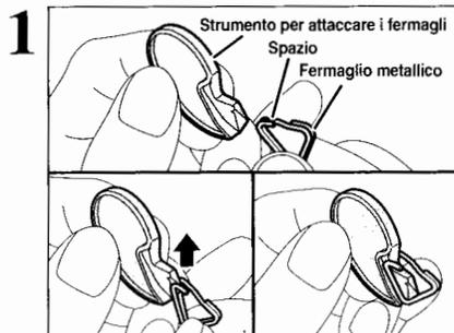
Controllando che il fermaglio metallico sia rivolto nel modo corretto, fate scorrere il fermaglio completamente nello strumento per attaccare i fermagli e aprite lo spazio nel fermaglio per la cinghietta da spalla.
